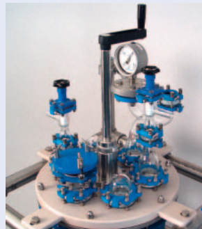
Cover plate with accessories Deckelplatte mit Armaturen
